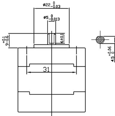
2、將電機齒輪壓裝至圖示高度要求
