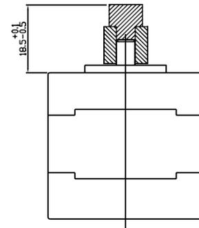
3、按照圖示方式，將減速箱垂直向下順利裝在壓好齒輪的電機上。嚴禁敲打
