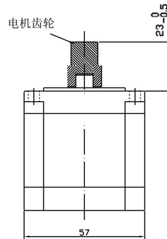
3、按照圖示方式。將減速箱垂直向下順利裝在壓好齒輪的電機上。嚴禁敲打。
