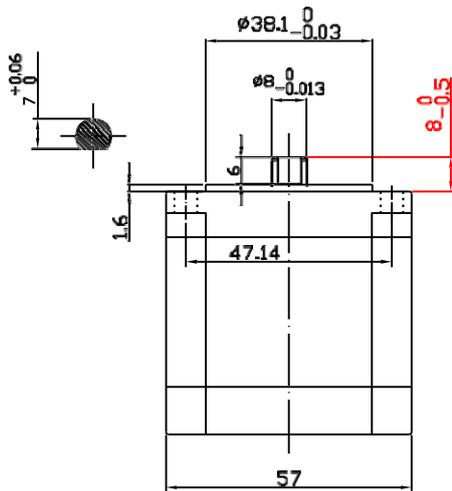
2、將電機齒輪壓裝至圖示高度要求
